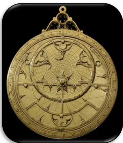
Astrolabium - przyrząd służący żeglarzom do nawigacji, pomiaru czasu oraz określania szerokości geograficznej i położenia ciał niebieskich.
